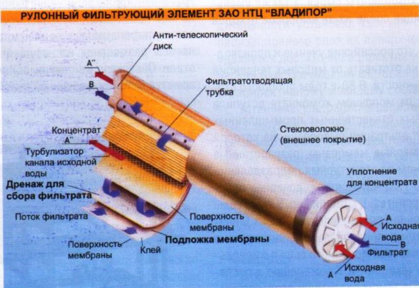
перпендикулярно фильтратотводящей трубке. Растворенные и диспергированные вещества, содержащиеся в исходном потоке, в сконцентрированном виде выводятся с противоположного торца элемента.
